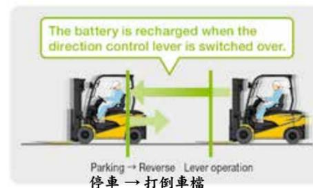
**05 升降/傾仰停止時** 裝卸作動(馬達)停止時，產生再生充電
