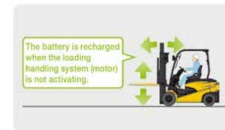
**03 剎車時** 踩下煞車踏板時，產生再生充電
